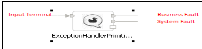
Şekil 3.25: Exception handler primitive'inin terminal dağılımı
