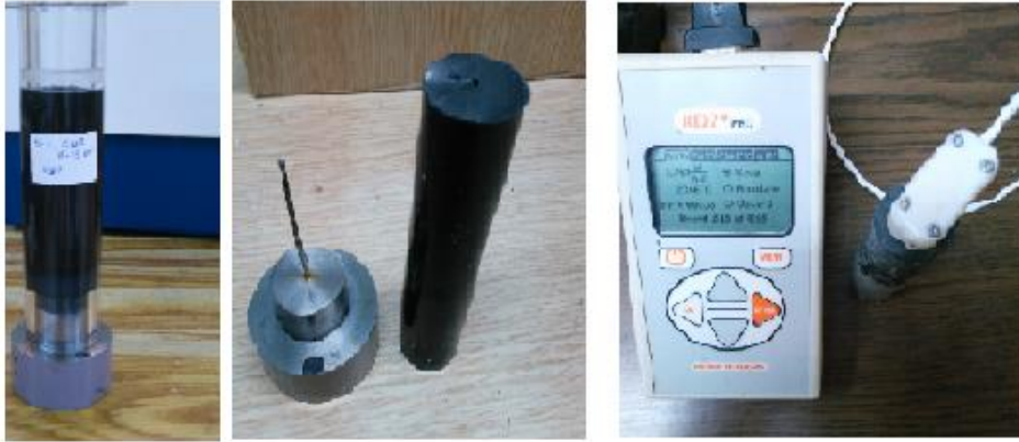
Şekil 2.4 NP/FDM'lerin ısı iletkenliklerinin test edildiği ısı iletkenlik ölçer KD2 PRO
