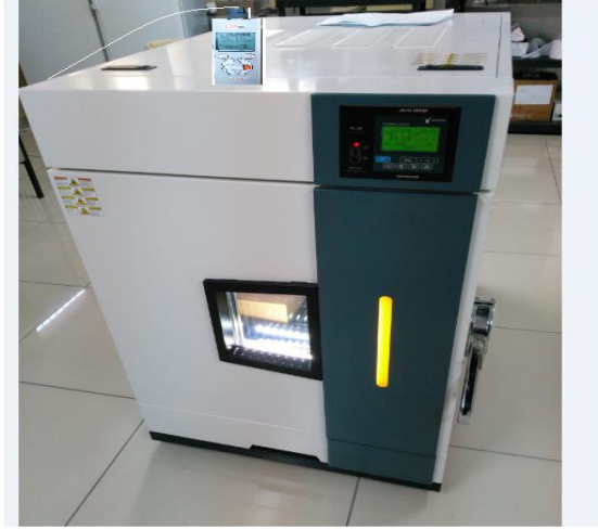
Şekil 2.5 JeioTech, iletkenlik ölçümleri için sabit sıcaklık ve nem şartlandırma kabini
