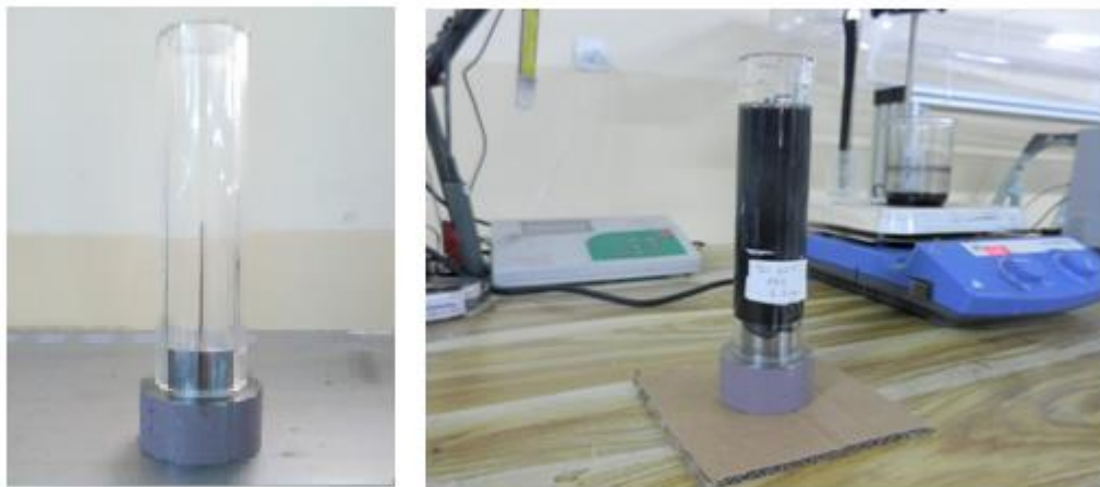
Şekil 2.3 a). FDM parafinlerin ve NPFDM kompozitlerin eritilerek döküm işlemi gerçekleştirilen silindirik kalıp.
