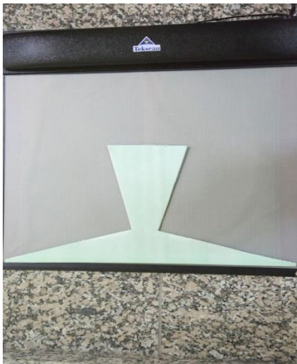
Resim 26. Statik ölçüm sırasında basma şablonu
