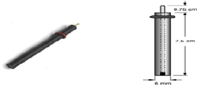
Şekil 2.4. Camı karbon çalışma elektrodu (Yılmaz, 2012).
