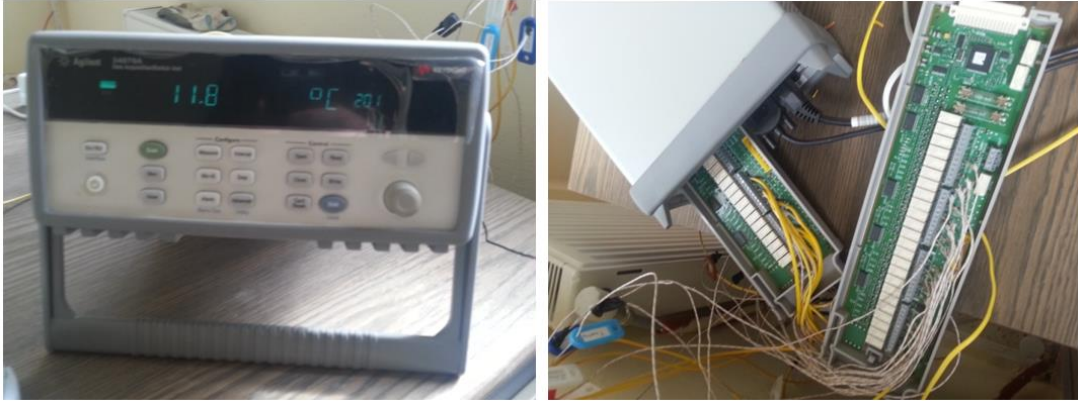
Şekil 3.14 Kullanılan veri toplama ünitesi ve modüller
