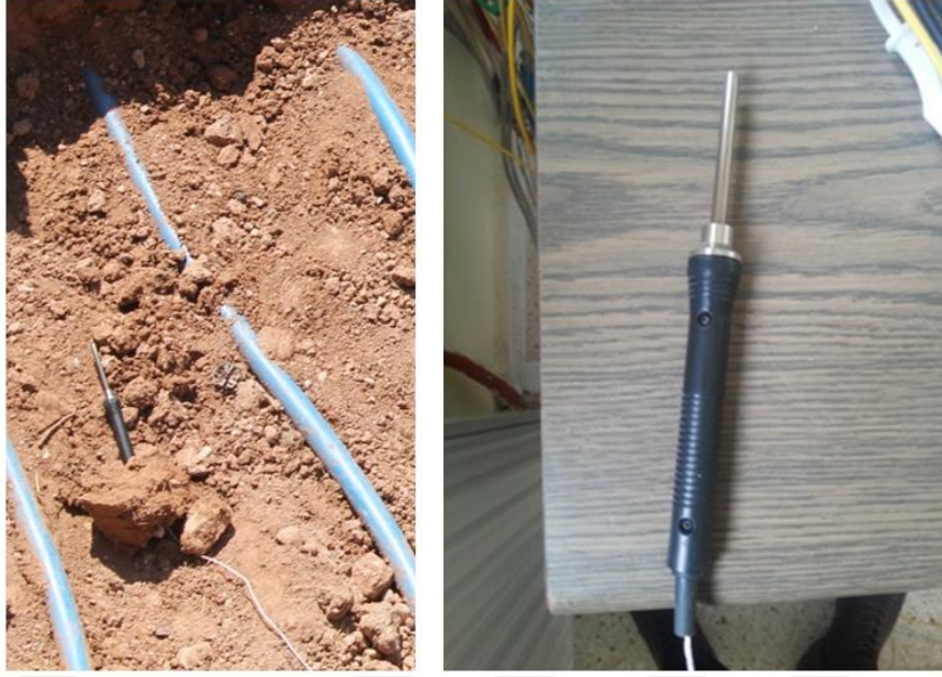
Şekil 3.13 Toprak sıcaklık ölçüm probu
