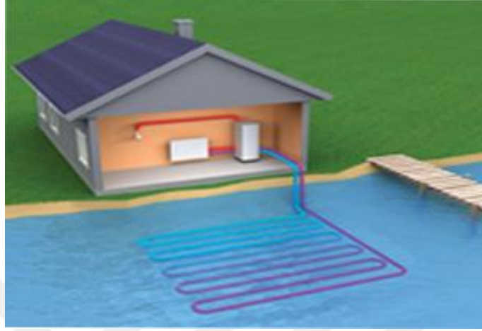
Şekil 2.7 Isı kaynağı olarak yerüstü suyu (url-2)
