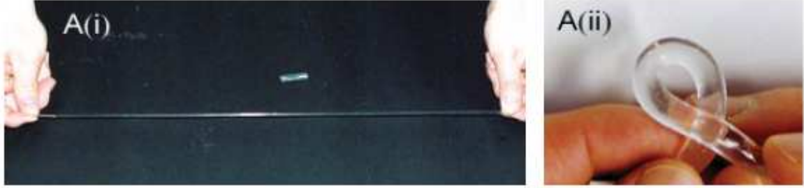
Şekil 2.13. Elde edilen hidrojelik kompozitlerin uzaması (Ai) ve bükülmesi (Aii)
