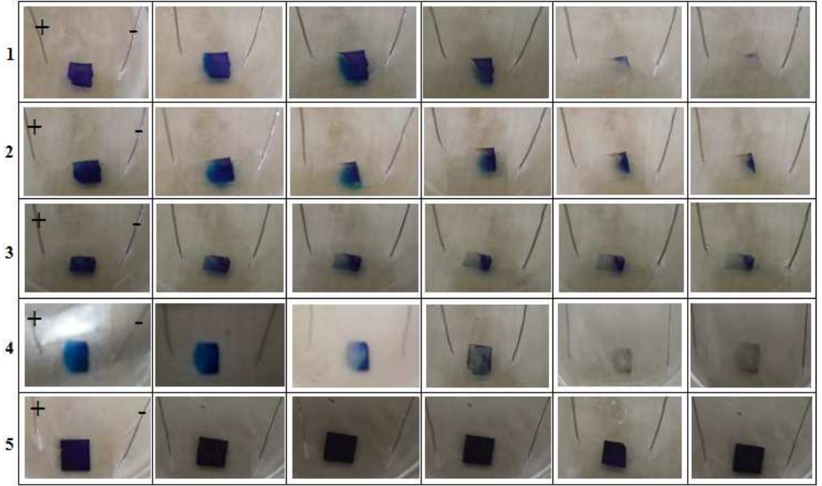
Şekil 4.18. MM yüklü PHG (1), PHG-E (2), PHG-E-L1(3), PHG-E-L2 (4), PHG-Cu-L2 (5) filmlerinin elektrik uygulanan (5 V) salım ortamında alınan görüntüleri
