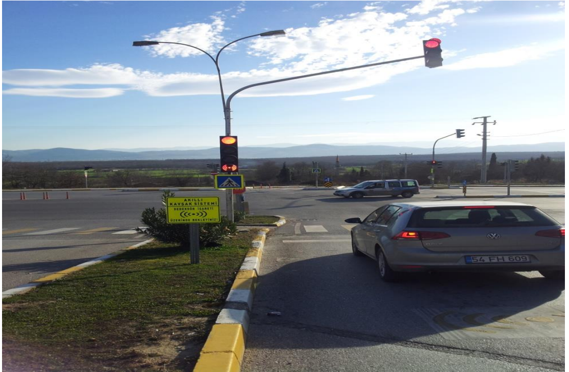
Şekil 4.20: Sistemin aracı algıladığının geri bildirim göstergesinde gösterilmesi
