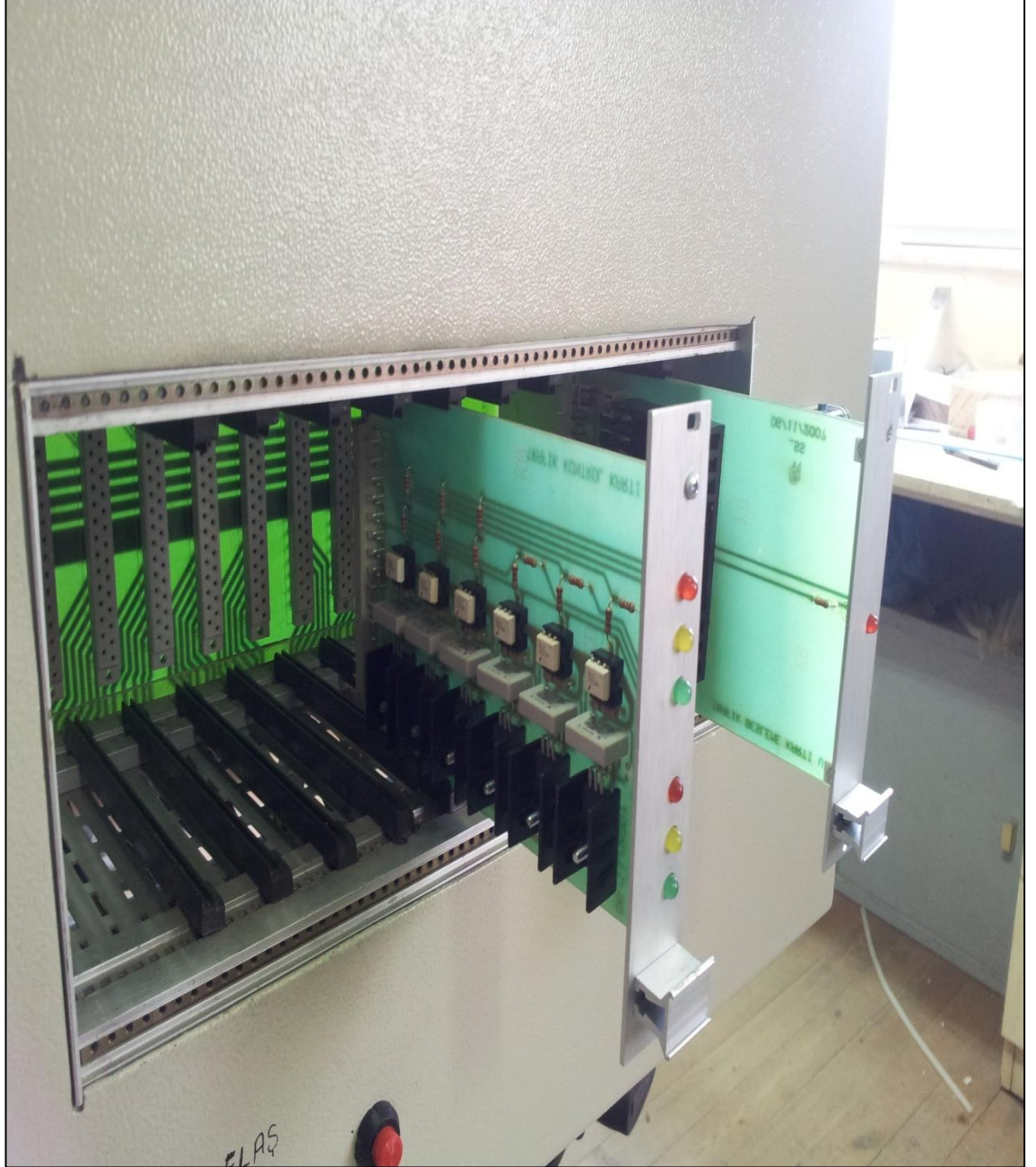
Şekil 4.10: KKC panosuna yerleştirilen besleme ve triyak kartı
