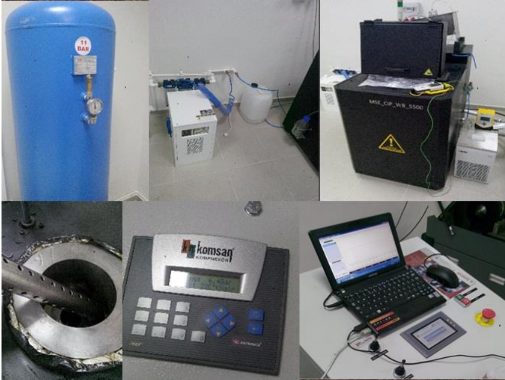
Şekil 2.4. Yüksek Hidrostatik Basınç Cihazı ve kısımları
