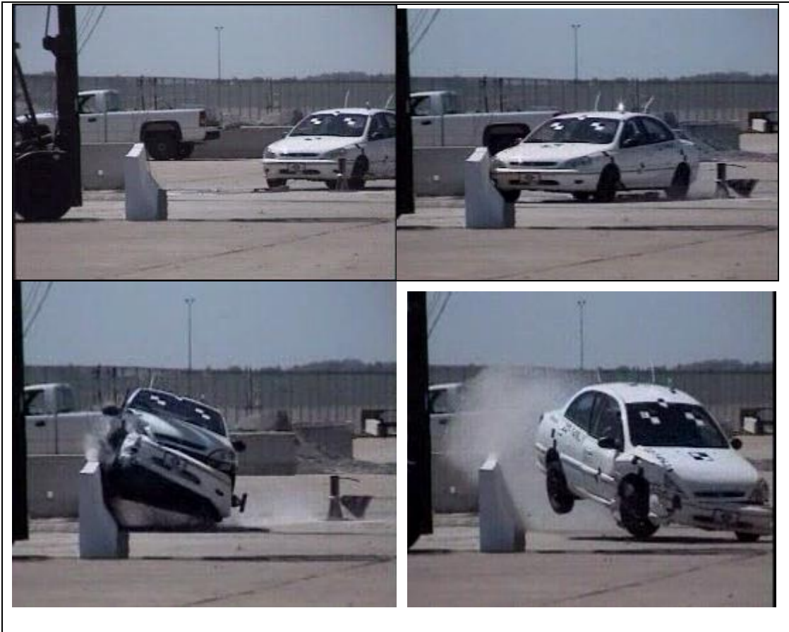
Şekil 5.1: F Tipi Otokorkuluk Çarpışma Testi (900kg, 100 km/sa, 25°)
