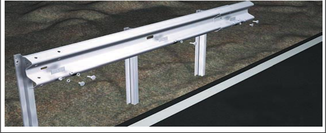
Şekil 1.2: Çelik oto korkuluk ve yapı elemanları
