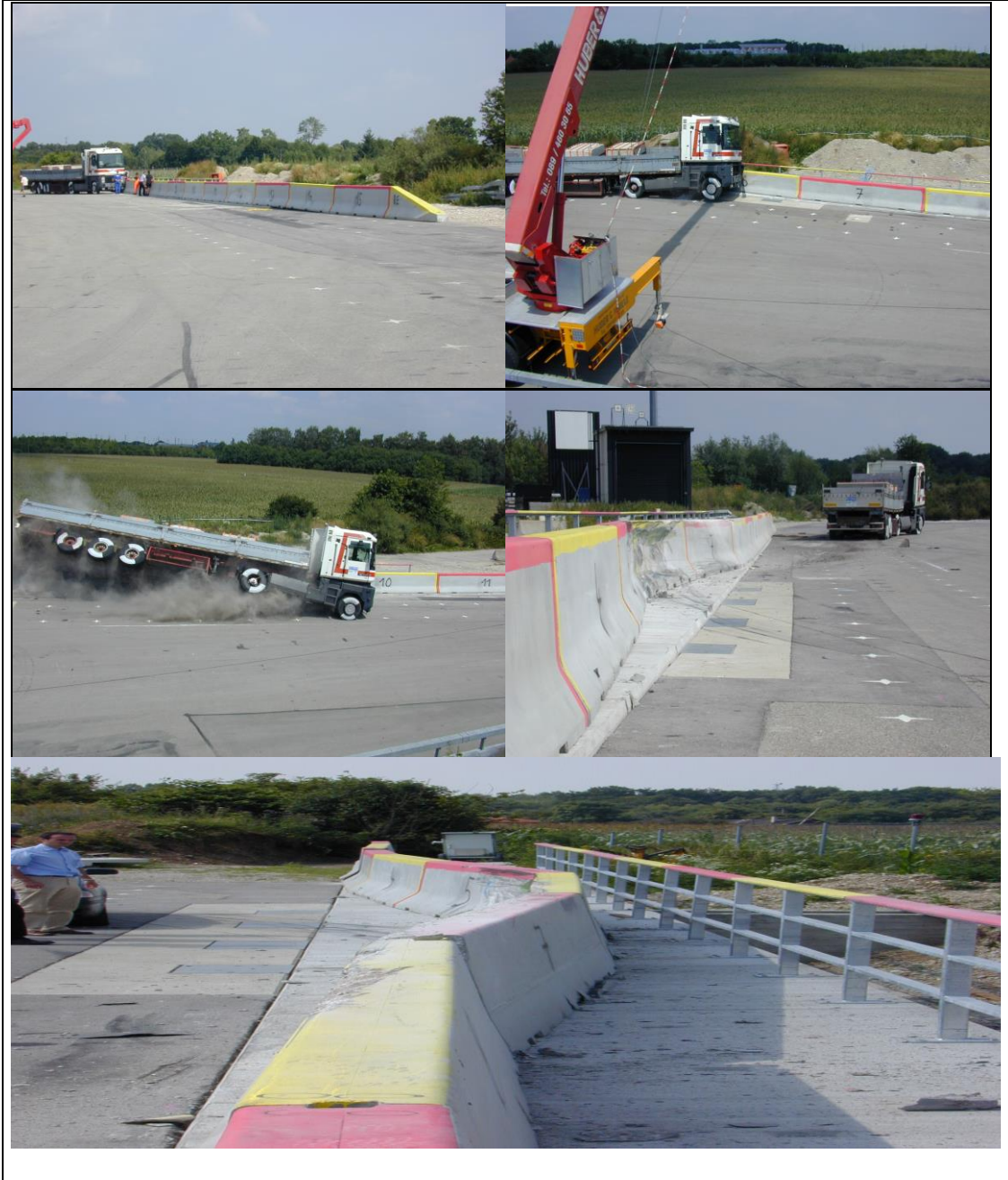
Şekil 5.4 Hareketli beton otokorkuluklar çarpışma testi
