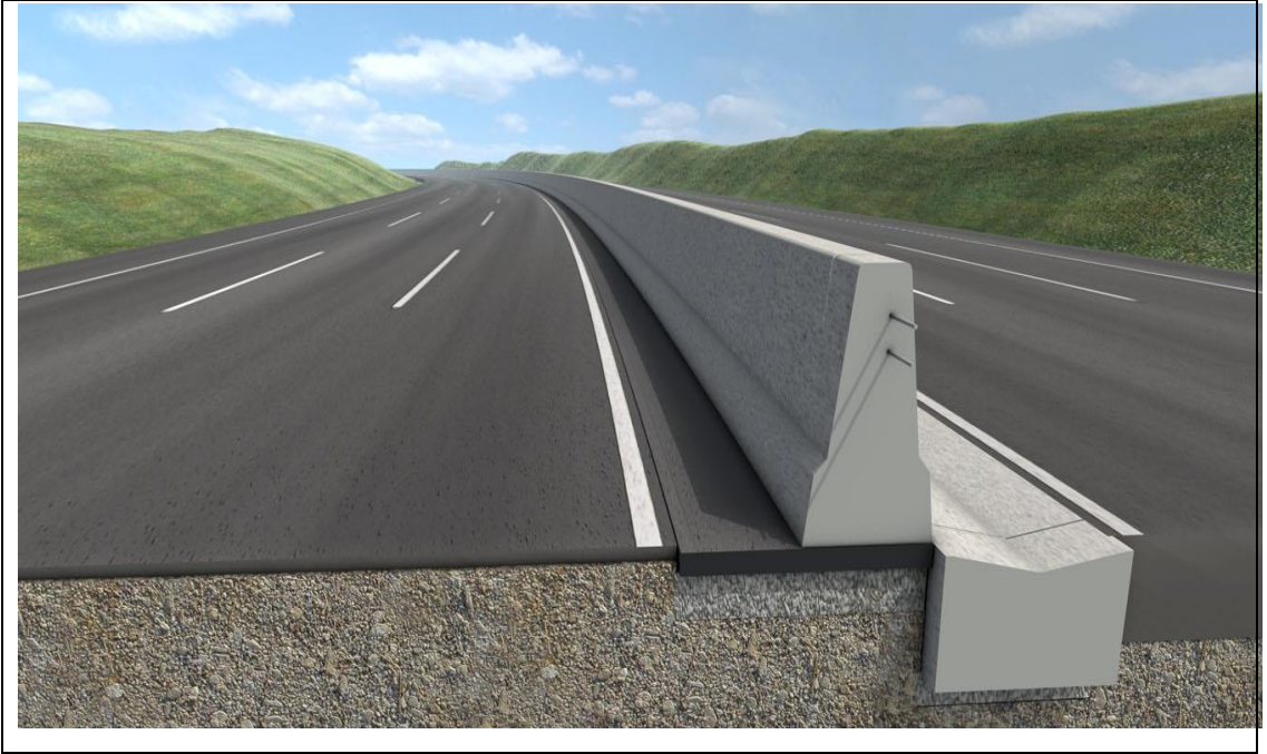
Şekil 1.25: Beton Oto korkuluklar
