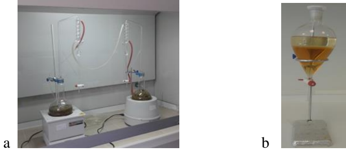
Şekil 3.1. a) Neo-clavenger aparatında su ile kaynatma işlemi, b) Özütleme işlemi
