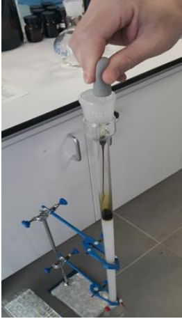
Şekil 3.5. Özütün Sephadex LH-20 kolon dolgu maddesine tatbik edilmesi
