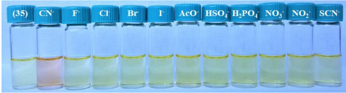
Şekil 4.1. EtOH/H 2 O (2,00 mL, 1:1) çözücü karışımında bulunan (35) (25 µM) çözeltisinin farklı anyonlar varlığında (10 ekiv.) gün ışındaki görünüşleri
