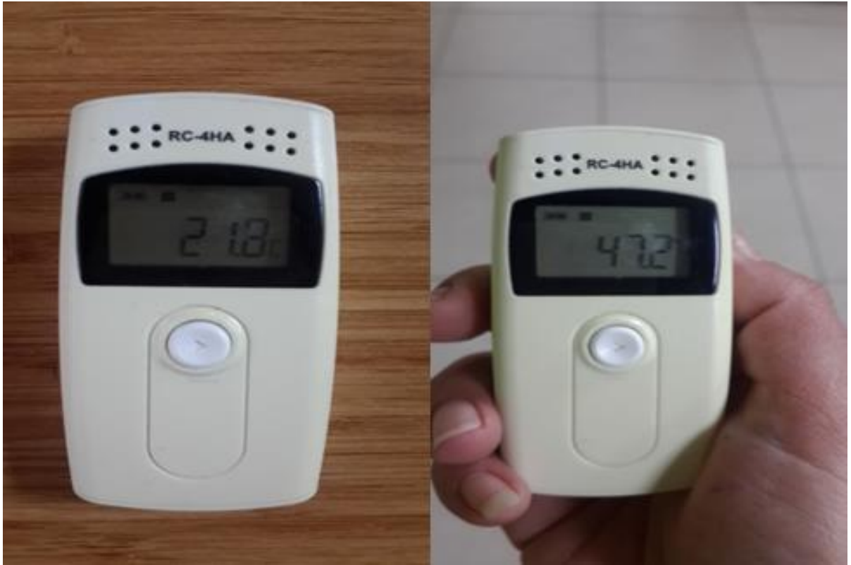
Şekil 3.3. Çalışmada kullanılan Sıcaklık-Nem Ölçer.
