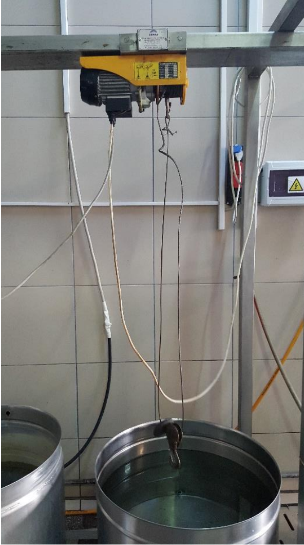
Şekil 5.6. Kilye bölümünde kullanılan teli değişmiş vinç
