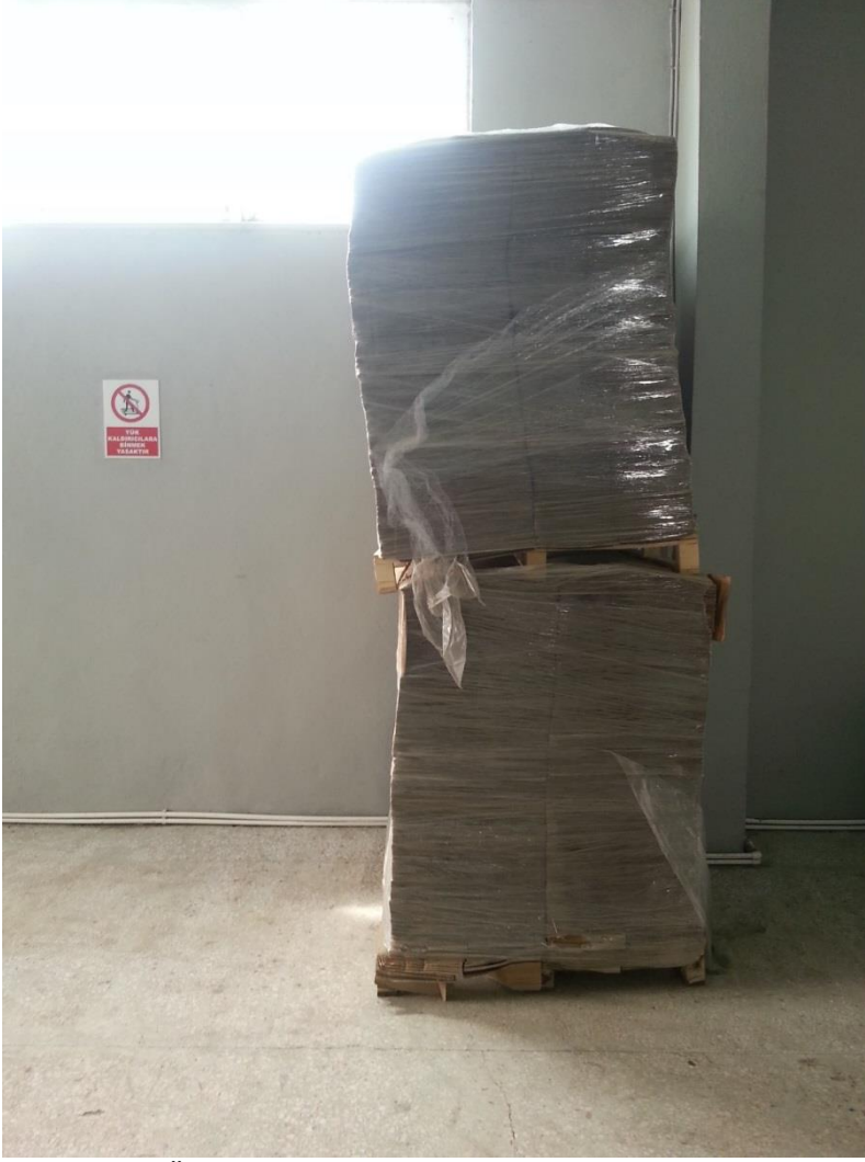
Şekil 4.14. Üzüm işleme bölümünde uygun olmayan şekilde depolanan malzemeler
