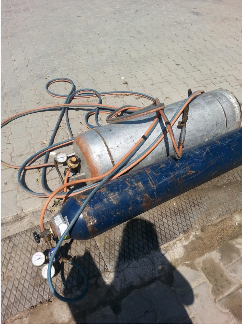
Şekil 4.24. Fabrikada kullanılan sabitlenmemiş (zincirsiz) yatay duran tüpler
