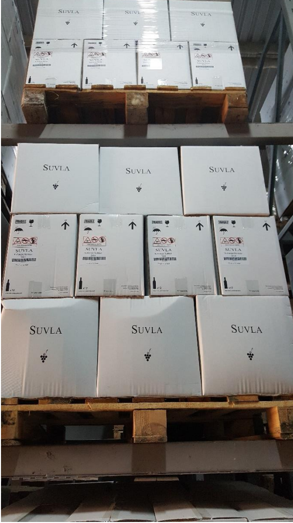
Şekil 4.19. Depo bölümünde uygun olmayan şekilde depolanan malzemeler
