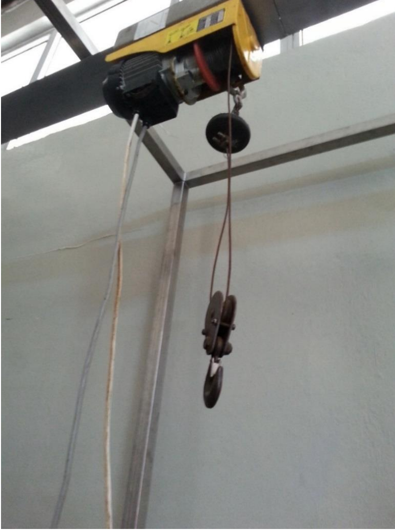
Şekil 4.9. Kilye bölümünde kullanılan düzensiz bakım yapılan taşıyıcı halatlar
