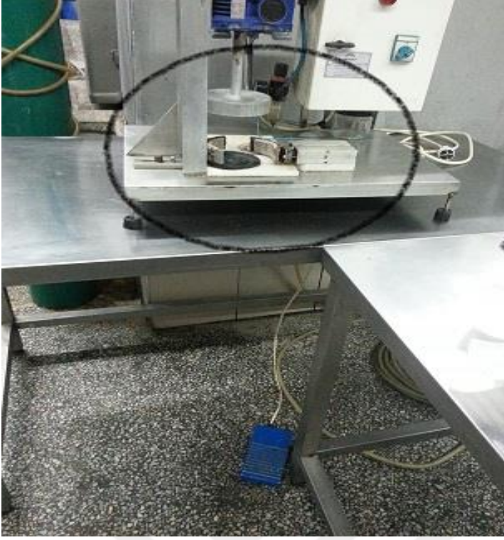
Şekil 4.8. Kilye bölümünde koruyucu kapağı olmayan kapak kapama makinesi
