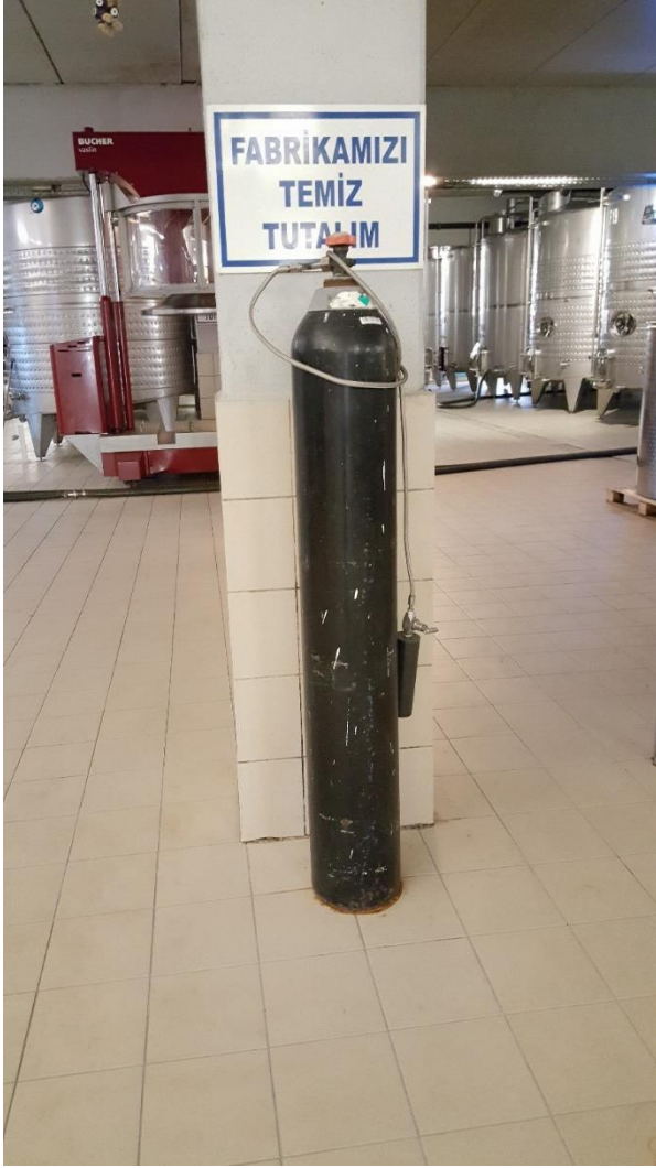
Şekil 4.25. Fabrika da kullanılan sabitlenmemiş (zincirsiz) tüpler
