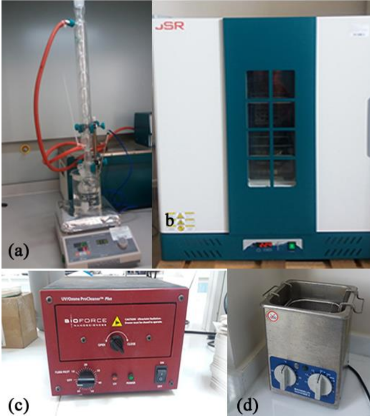
Şekil 3.5. a) Manyetik karıştırıcı ve su sirkülatörü b) Etüv c) Uv-ozon temizleyici d) Ultrasonik banyo
