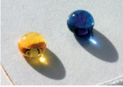
Şekil 2.14. PFOTS ile modifiye edilmiş SN yüzeyler üzerinde su hegzadekan (sarı) ve su (mavi) damlaları (Zimmermann ve ark., 2008)
