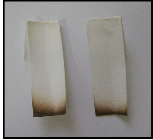
ŞEKİL 9: H 2 S deneyi sonucunda kurşun asetat kağıdında meydana gelen siyahlanma
