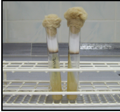
ŞEKİL 9: H 2 S deneyi sonucunda kurşun asetat kağıdında meydana gelen siyahlanma
