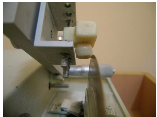
Resim 12- Örneklerin kesme cihazına sabitlenmesi.
