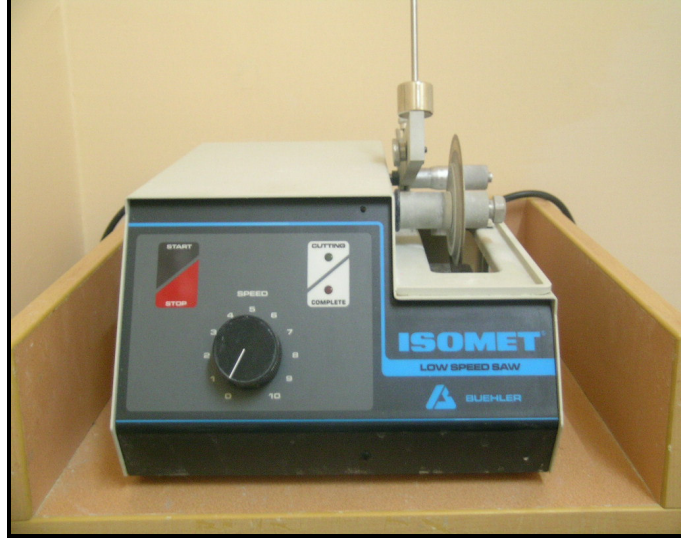
Resim 1. Dřk hızda dnen su soęutmalı kesme cihazı
