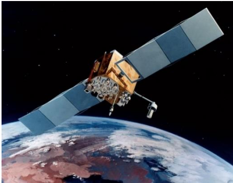
Şekil 1.24. Navstar-2F GPS uydusu, U.S. Air Force (URL-11)
