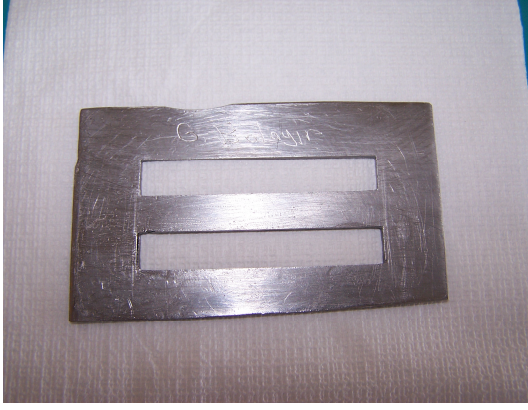
Şekil 3.1.2 Transvers dayanım test örneklerinin hazırlanmasında kullanılan paslanmaz çelik kalıp
