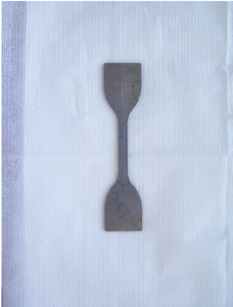
Şekil 3.1.1 Çekme dayanım test örneklerinin hazırlanmasında kullanılan paslanmaz çelik kalıp
