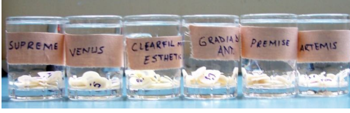
Resim 5. Su absorpsiyonu ve çözünürlük testi için hazırlanan örnekler
