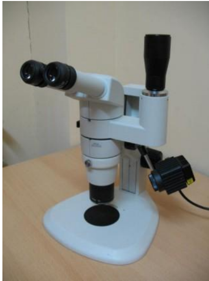
Şekil 3.29: Mikrosızıntı değerlendirilmesinin yapıldığı stereomikroskop
