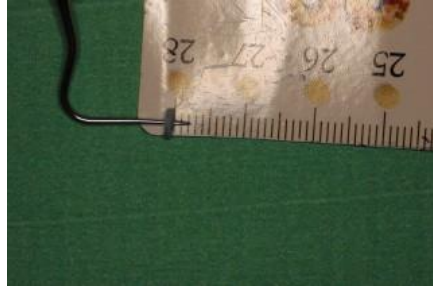
Şekil 3.4: Sond üzerinde 2 mm'in belirlenmesi
