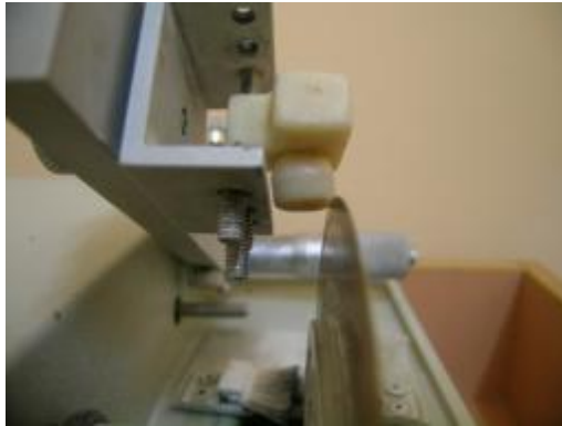
Şekil 3.18: Örneklerin kesme cihazına sabitlenmesi
