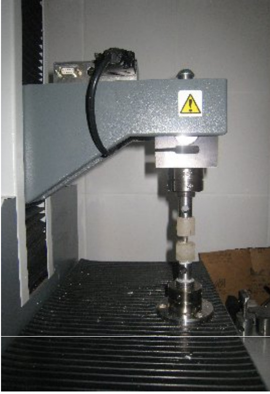
Şekil 31. Test örneklerinin cihazın alt ve üst parçasına yerleştirilmiş hali.
