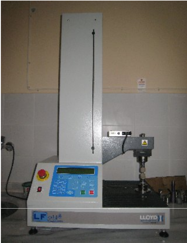
Şekil 30. Çekim kuvveti testinde kullanılan üniversal test cihazı (Lloyd LF plus, Ametek Inc. Lloyd Instruments, Leicester, İngiltere)
