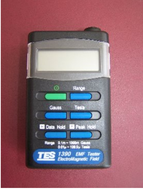
Şekil 28. A) Manyetik alan değerlerinin tespitinde kullanılan gaussmetre (Tes 1390, TES Electrical Electronic Corp, Tayvan), B) Örneklerin tutturulmasında kullanılan yapıştırıcı ajan.
