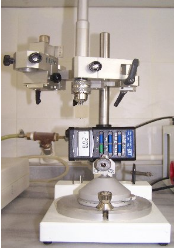
Şekil 29. Manyetik alan şiddetinin tespiti için kullanılan düzenek.
