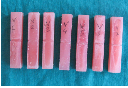
Şekil 3.2.3 Darbe dayanıklılık test örnekleri
