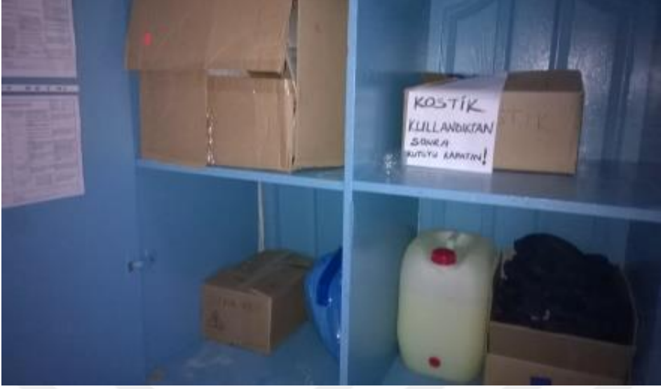
1.a. Kimyasalların depolama matrisine uygun depolanmaması
