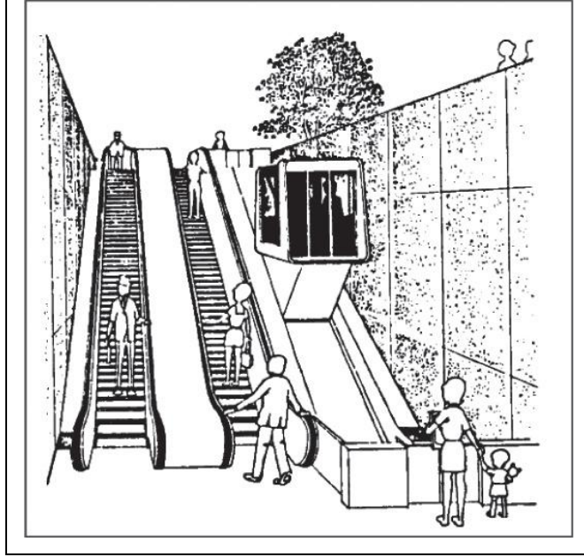
Şekil 4.6: Merdiven eğiminde eğik asansör
