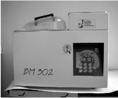
Şekil 3.4.2. Ataşman sistemlerinin 14 gün boyunca bekletildiği sirkülasyonlu su banyosu cihazı. 2
