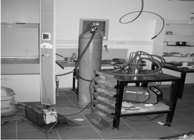
Şekil 3.1. Argon gazı altında ark ergitme sistemi
