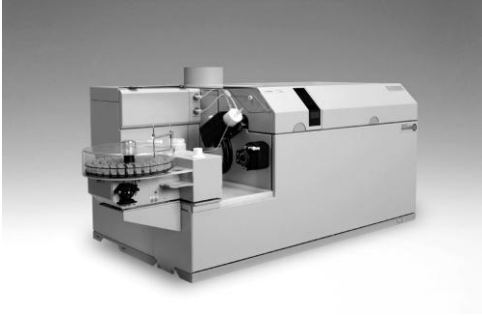
Şekil 3.4.3. Korozyon testi için kullanılan ICP-MS test cihazı.
