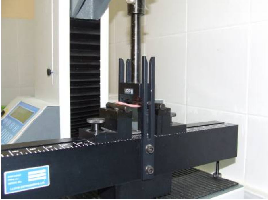
Şekil 3.8. Transverse dayanıklılık testi
