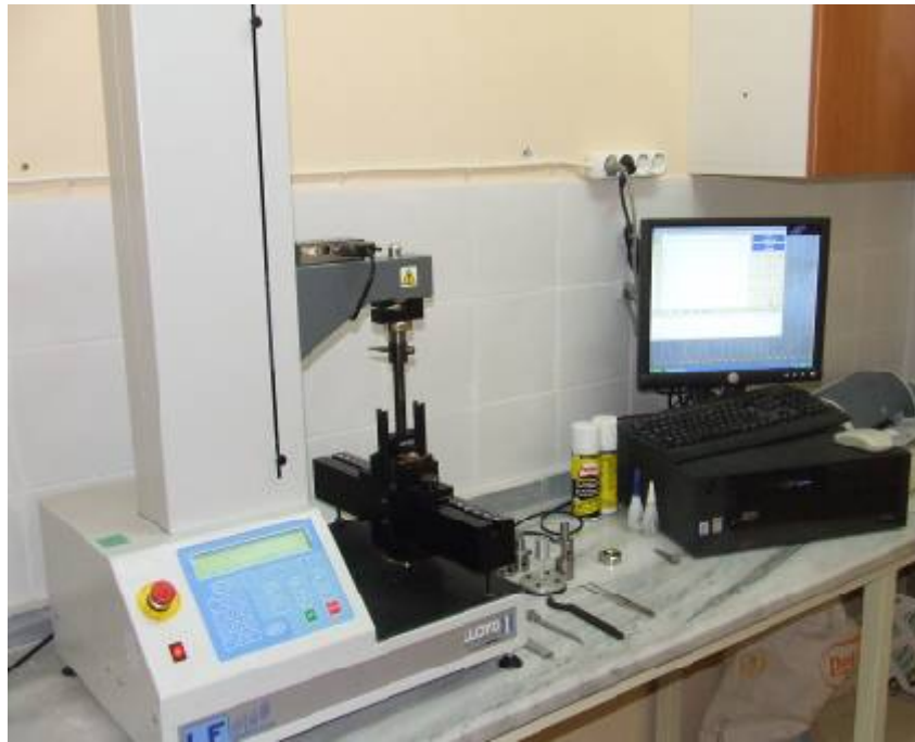
Şekil 3.7. Eğme testi cihazı (Lloyd instruments)
