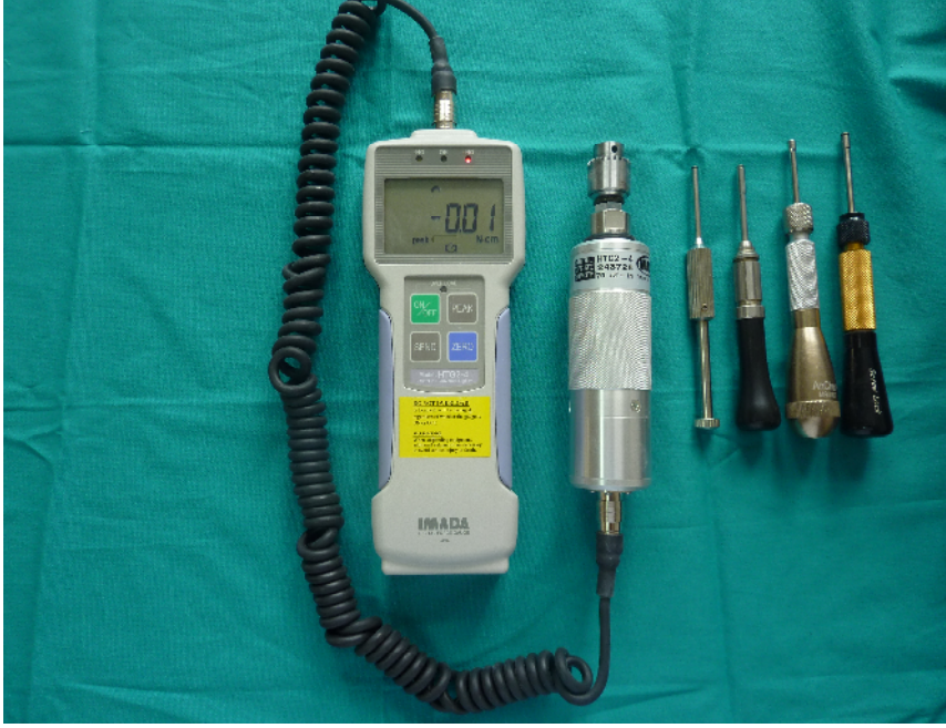
Şekil 3. 10 HTG-2N (IMADA, Toyohashi, Japan) marka portatif dijital tork ölçme cihazı ve mini vidaları yerleştirmek için kullanılan screwdriver'lar
