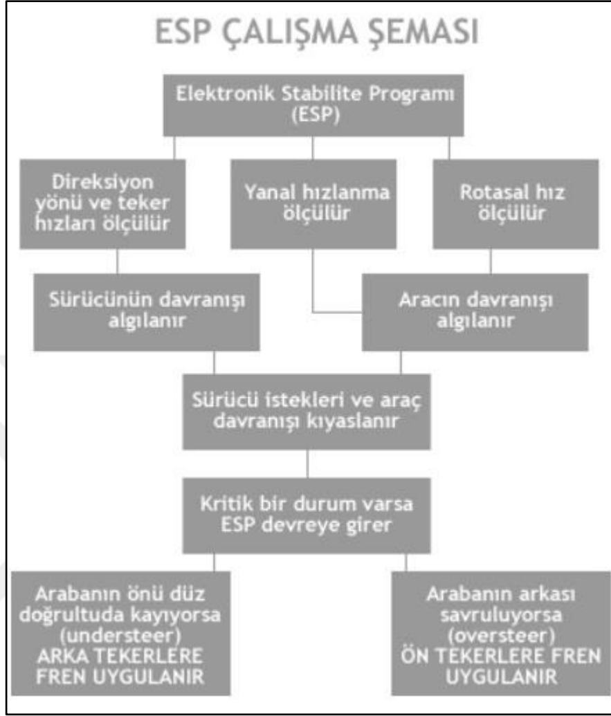
Şekil 2.5: Elektronik stabilite programı çalışma şeması
