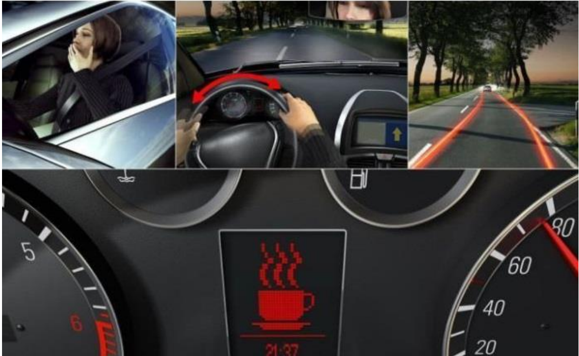
Şekil 3.1: Yorgunluk tespit sistemi
