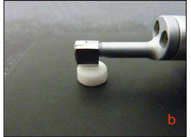
Şekil 3. 13: a: Sinterize öncesi örneklerin yüzeý pürüzlülük değeri ölçülmesi b: Sinterize sonrası örneklerin yüzeý pürüzlülük değeri ölçülmesi.
