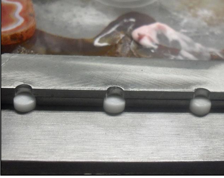
Şekil 3. 16: Zirkonya alt yapıların metal kalıba yerleştirilmesi.
