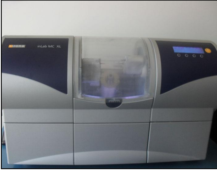
Şekil 3. 4: IPS e.max ZirCAD örneklerin hazırlanmasında kullanılan cihaz (Sirona InLab MC XL, Bensheim, Almanya).
