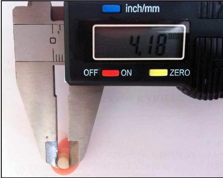
Şekil 3. 15 : Veneer seramik kısımlarının çaplarının dijital kumpas ile ölçülmesi.
