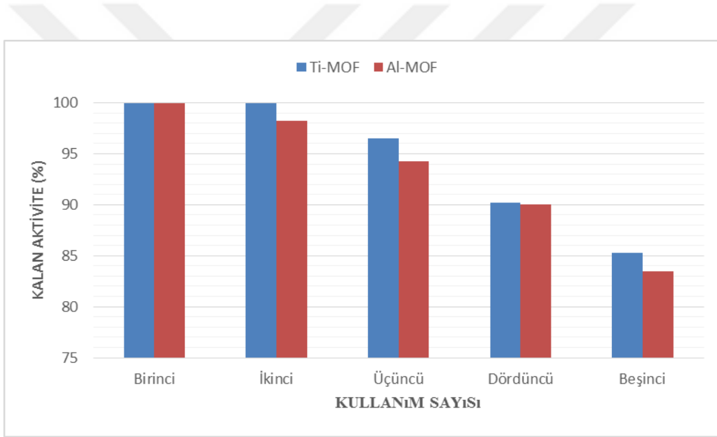
Şekil 4.6. Seçilmiş adsorbanlarda kullanım sayısının adsorbanların aktivitelere etkisi
