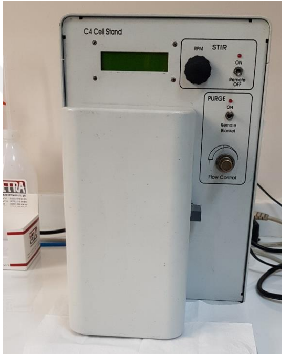
Şekil 3.5. CH Instrument 617E marka Elektrokimyasal Çalışma Hücresi
