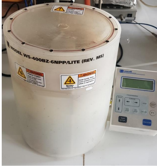
Şekil 3.6. Laurell WS-400 BZ-6NPP/LITE marka döndürerek kaplama cihazı
