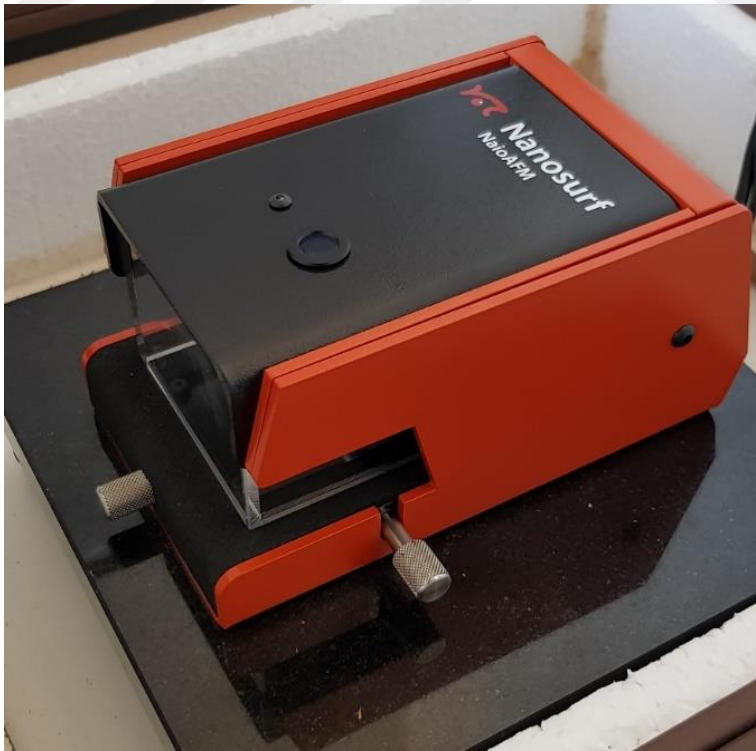
Şekil 3.4. NanoSurf Naio marka AFM cihazı
