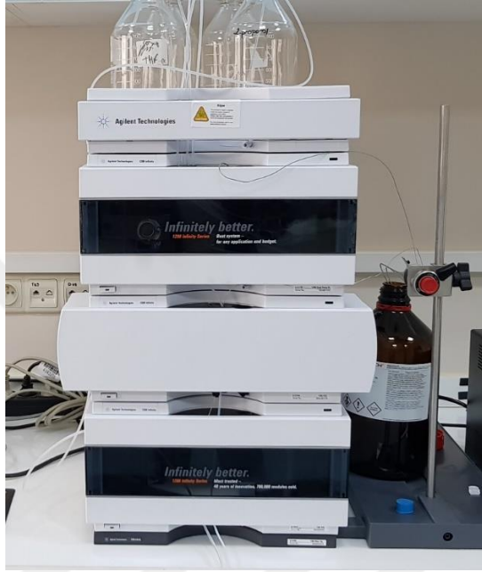
Şekil 3.2. 1260 Infinity II GPC Agilent marka GPC cihazı
