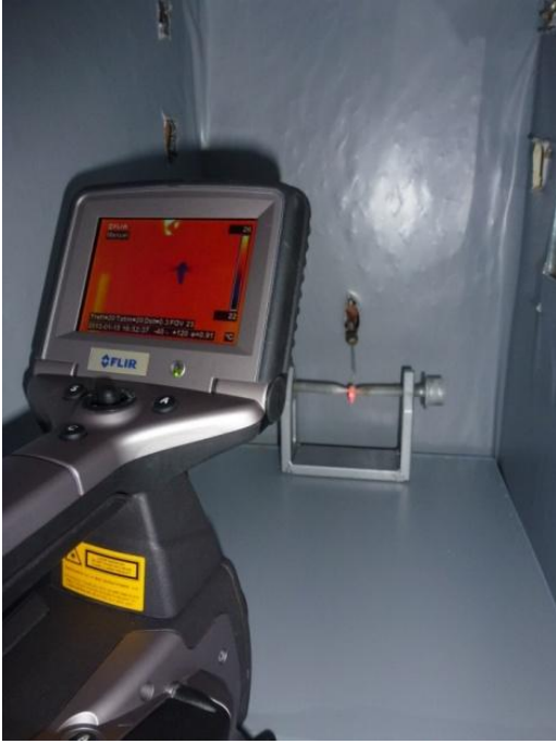
Şekil 3.14 Fiber optik uç, sabitleyici düzeneğe yerleştirilmiş diş ve termal kamera konumu
