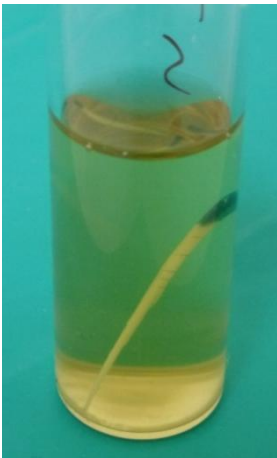
Şekil 3.2 İçerisinde 5 ml BHI bulunan cam tüp ve içerisine alınan kağıt kon
