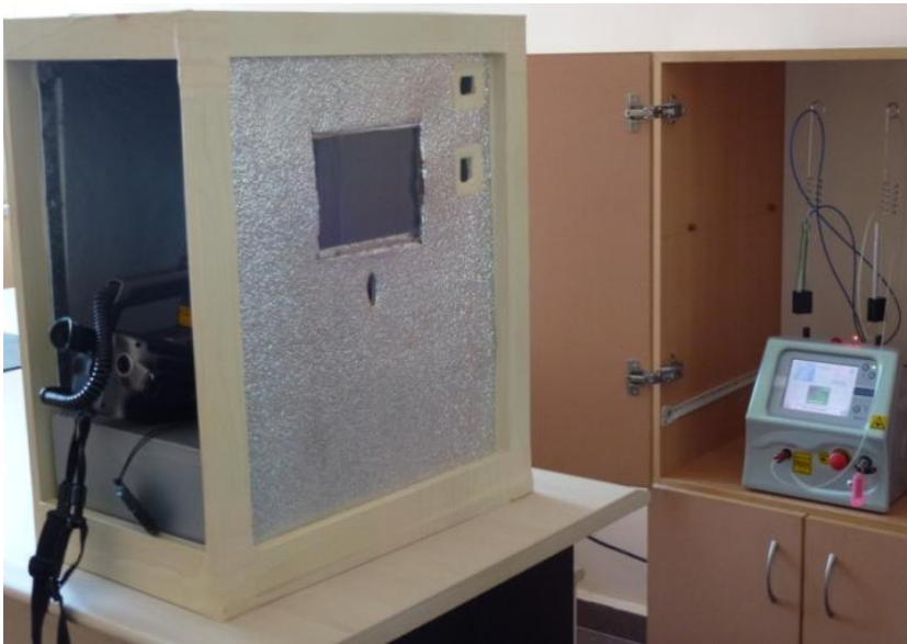
řekil 3.11 KTP lazer uygulanması sırasında meydana gelen sıcaklık deđiřiminin incelendiđi deney düzeneđi
