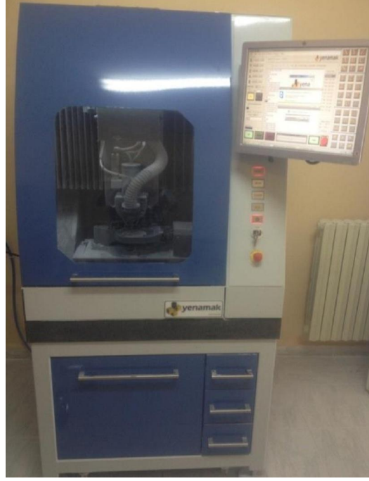
Resim 4: Titanyum ve Zirkonyum metal alt yapıların hazırlandığı CAD/CAM cihazı
