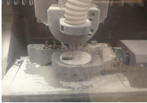
Resim 5: Zirkonyum metal altyapı örneklerinin CAD/CAM ile hazırlanışı
