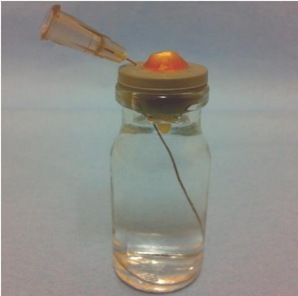
Şekil 3.5 Apikalden taşan bakteri miktarının incelendiği deney düzeneği
