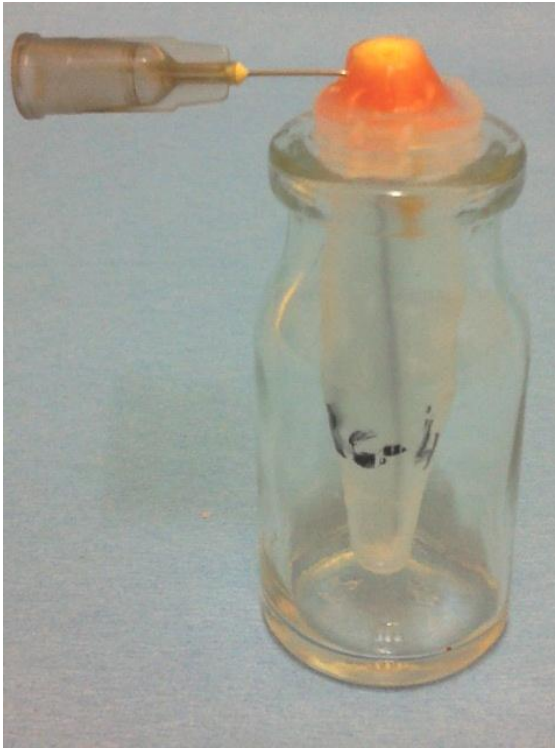
Şekil 3.1 Apikalden taşan sıvı ve debris miktarının incelendiği deney düzeneği
