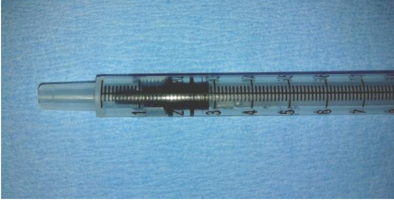
Şekil 3.2 Preparasyon sırasında taşan sıvı miktarının ölçüldüğü kalibrasyonlu insülin enjektörü
