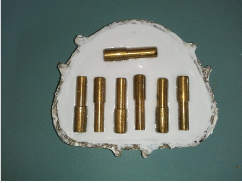
Şekil 3.7: Pirinç kalıpların muflaya alınması
