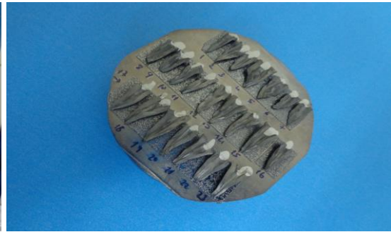
Şekil 3.18: Altın-paladyumla kaplanmış kökler
