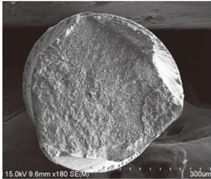
Şekil 2.12 Wave One eğenin kesiti
