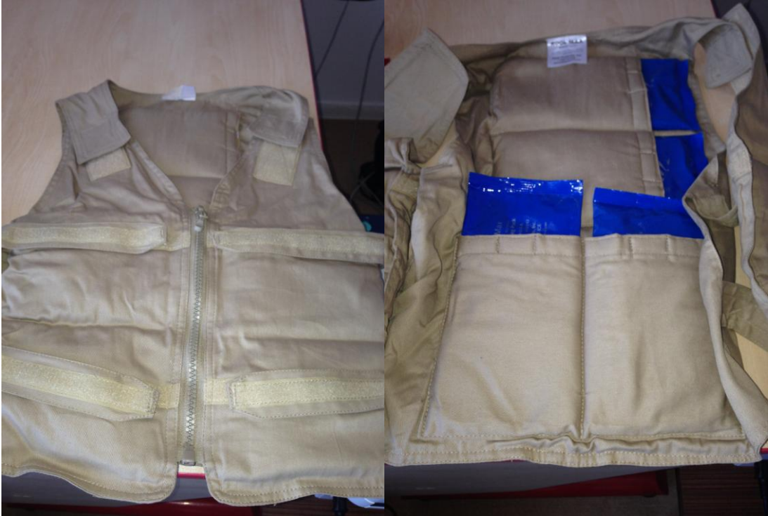
Resim 1. Araştırmada kullanılan soğutucu giysi ve soğutucu giysi ceplerine buz paketlerinin yerleşimi
