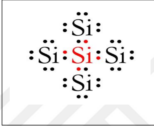
Şekil 3.2: Has yarı iletkende düzgün kristal yapı (Si)
