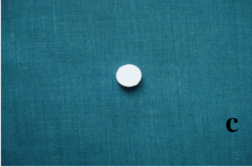
Şekil 3.4 : a: Kazıma işlemi tamamlanmış ZrO_2 disk b: Örneklerin konnektörlerinden ayrılmamış hali c: Konnektörlerinden ayrılmış sinterlenmemiş örnek
