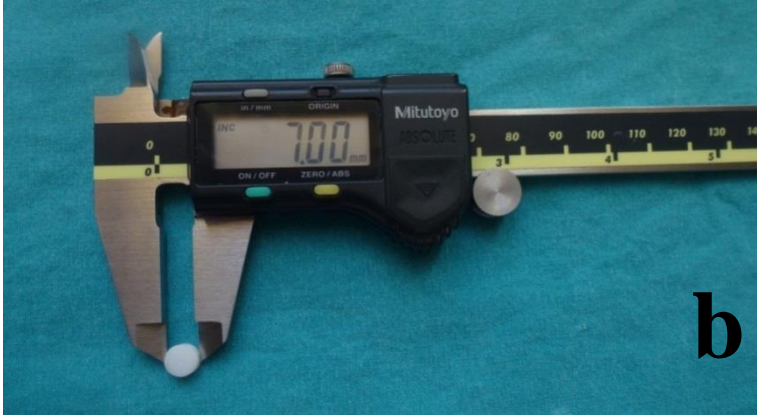
Şekil 3.6: a: Sinterlenmiş örneğin kalınlığının dijital kumpasla ölçülmesi b: Sinterlenmiş örneğin çapının dijital kumpasla ölçülmesi
