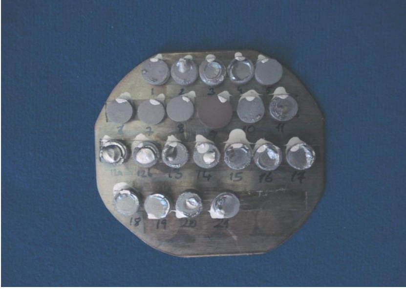
Şekil 3.22: Alüminyum blok üzerine yapıştırıcı bir bant yardımıyla sabitlenmiş örnekler
