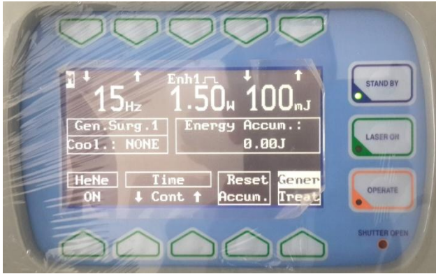
Şekil 3.11 Nd:YAG lazer cihazının parametreleri ve örnek üzerine uygulanması
