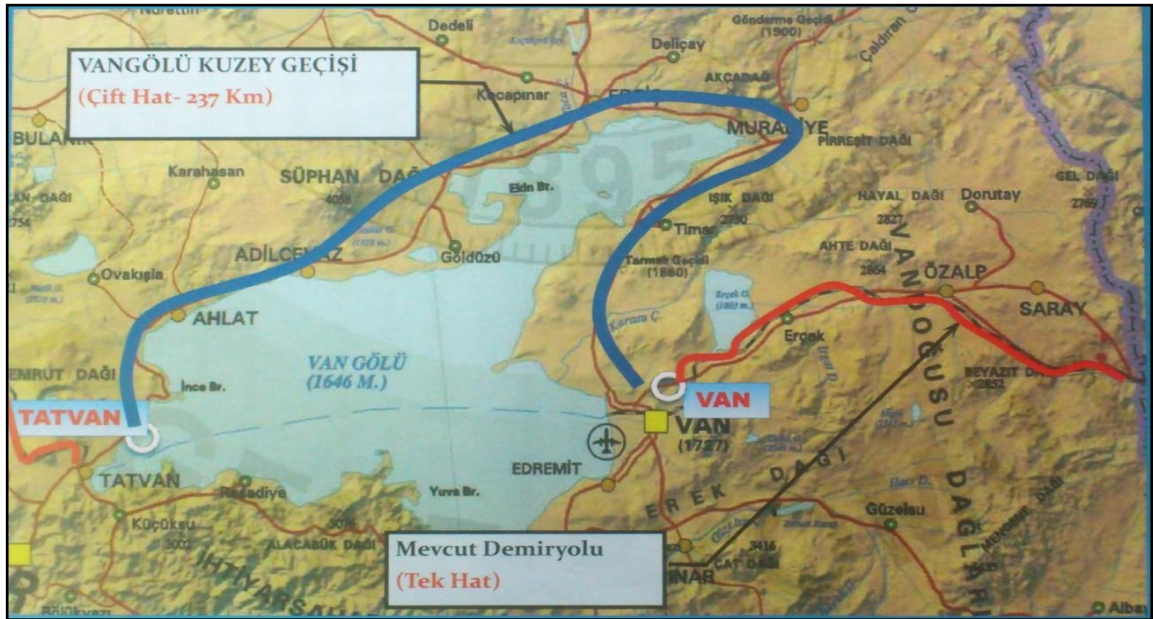
Şekil 2.8: Van Gölü kuzey geçişi demiryolu hattı projesi
