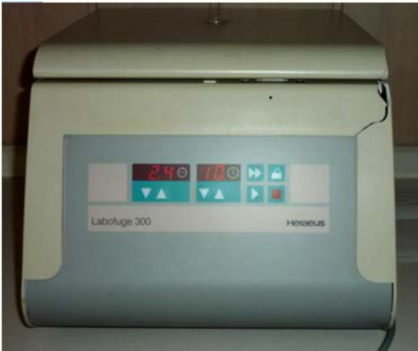
Şekil 3-9 Kırmızı renkli monovet santrifüj cihazına yerleştirilerek 2400 devir/dk'de 10 dakika boyunca santrifüj edilmesi işlemi.
