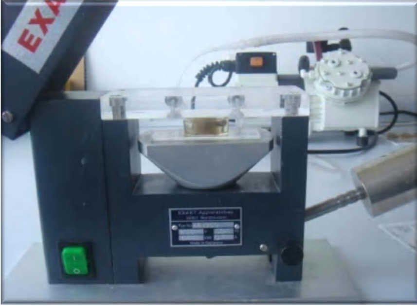
Şekil 17:Örneklere içeren metil metakrilat rezin blokların lam üzerine vakum altında yapıştırılması
