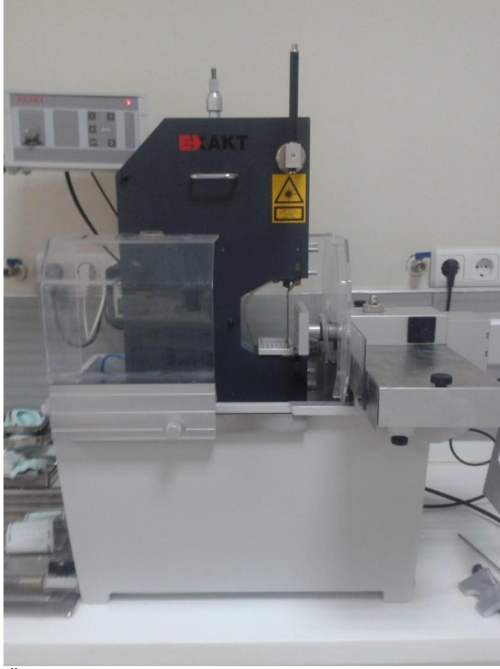
Şekil 18:Örneklerden kesit almak için kullanılan Exact sert doku kesme cihazı
