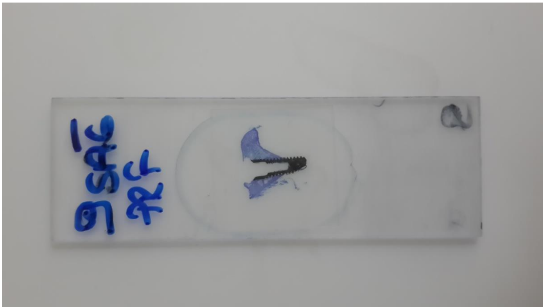
Şekil 19:Aşındırma cihazında 40 µm kalınlığa kadar zımparalanmış örnek
