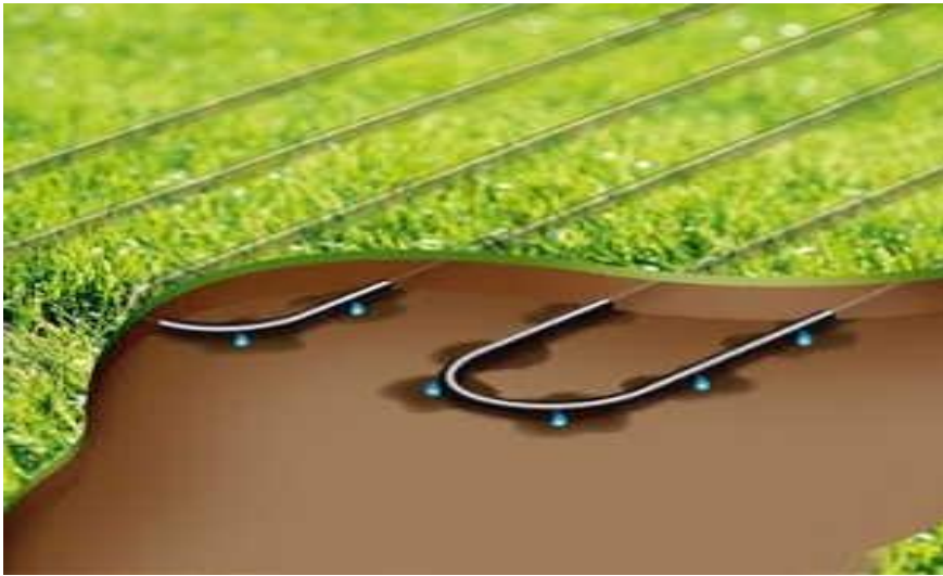
Şekil 2.8. Toprak altı damla sulama yöntemi (URL 8)
