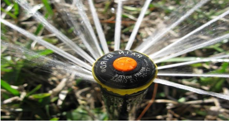
Şekil 2.5. Rotary yağmurlama başlığı (URL 5)
