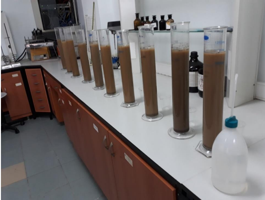
Şekil 3.3. Toprak bünyesi analizi
