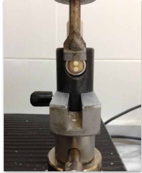
Şekil 3.22 Makaslama bağlanma dayanımı için universal test cihazına bağlanmış olan bir örnek görüntüsü
