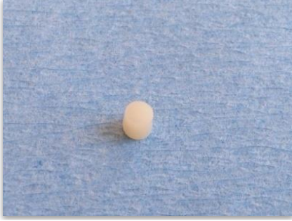
Şekil 3.6 Tesviye işlemi tamamlanmış silindirik LAVA Ultimate numunesi
