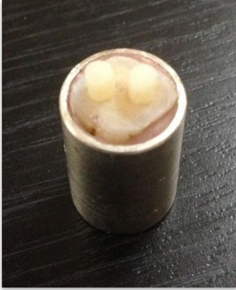
Şekil 3.21 Bakır ano içerisinde sabitlenmiş diş
