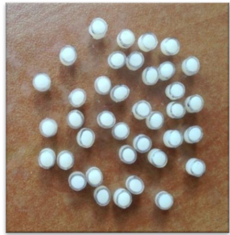
Şekil 3.8 Şeffaf plastik kalıplar içerisine yerleştirilmiş kompozit rezin numuneler
