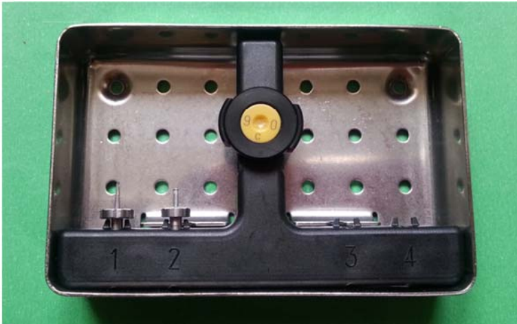
Şekil 2.6 DIAGNOdent pen cihazının safir uçları ve kalibrasyon diskini
