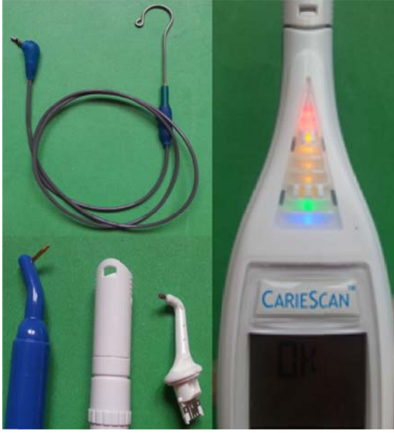
Şekil 2.10 CariesScan PRO cihazının dudak klipi, uçları ve renk kodları göstergesi
