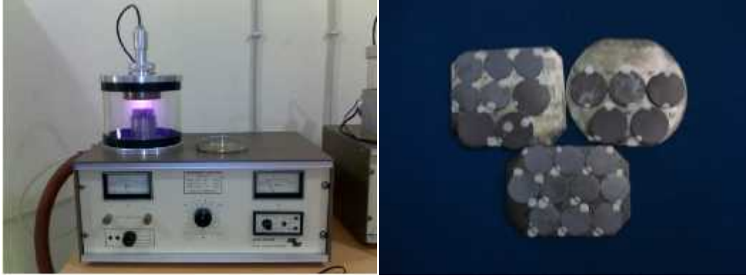
ekil 3.14. a. Altın kaplama cihazı, b. Altınla kaplanmış örnekler
