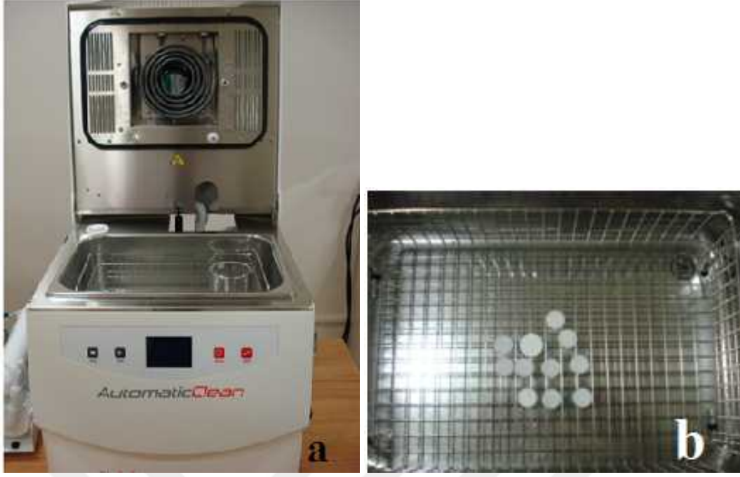
ekil 3.11: a. Ultrasonic banyo cihazı, b. Örneklerin ultrasonic banyo cihazında temizlenmesi
