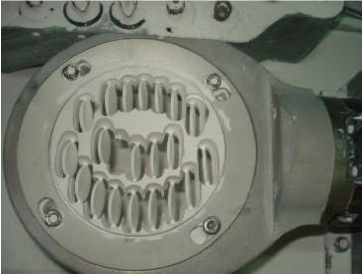
ekil 3.4. Frezleme işlemi yapılmış yarı sinterize zirkonyum oksit disk
