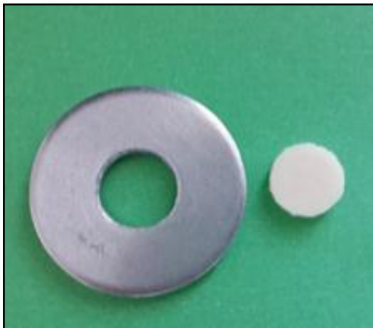
Şekil 15: Yüzey pürüzlülüğü deneyi için kullanılan kalıp ve hazırlanan örnek
