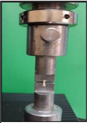
Şekil 22: Elde edilen çubuğun mikrogerilim cihazına yerleştirilmesi
