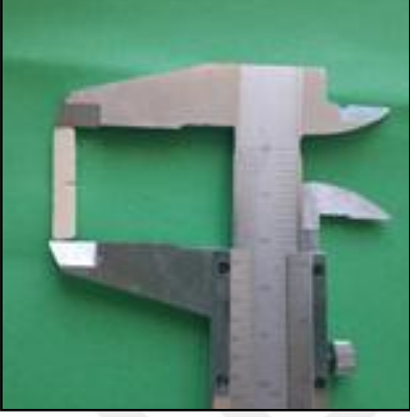
Şekil 13: Örneklerin kumpasla ölçülmesi
